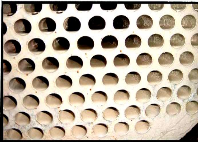
ท่อระบายความร้อนที่มีตะกรันจับหนา
